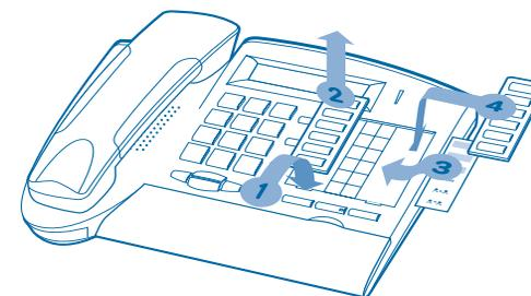
1. Insérez un objet à bout plat dans l'encoche (1 encoche par bloc de touches).
