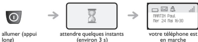
Si l'afficheur ne s'allume pas ou si l'icône du niveau de batterie clignote, recharger la batterie.
